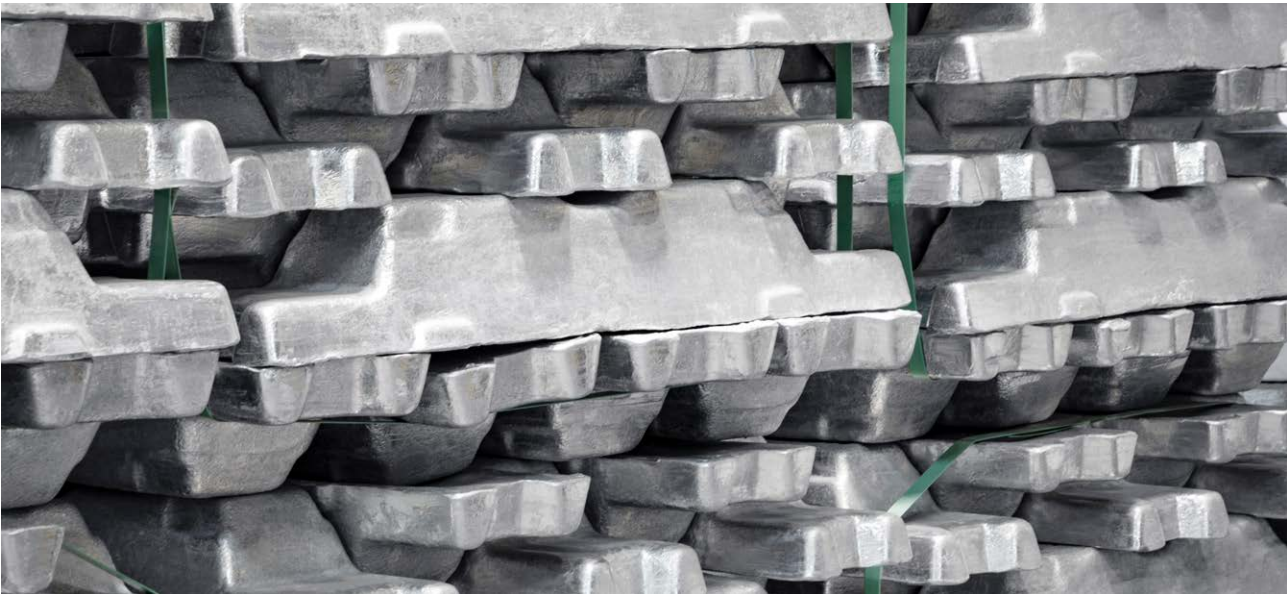
Göt och tackor (se bild) av primäraluminium används som insatsmaterial i Gränges produktion.
